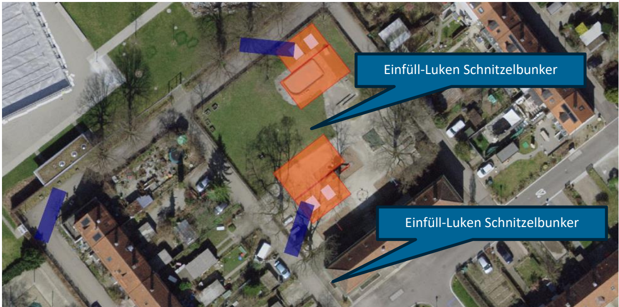
Skizze mit 2 Standorten für Hackschnitzel-Zentrale inkl. Silo (rot) und Lastwagen (blau) für Hackschnitzel-Anlieferung. Einstiegsbauwerk sowie Kamin wurde nicht eingezeichnet.
